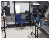
sur fond noir mat (papier cartonné épais) et usage de deux sources lumineuses : l'une directe (leds), l'autre par flashes avec filtres polarisés orientables.
